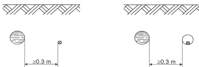
Figura 4: Incroci e parallelismi tra cavi di energia in tubazione e tubazioni di gas con densità non superiore a 0,8 non drenate con pressione massima di esercizio >5 Bar
